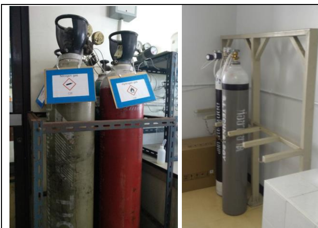
รูปที่ 38 การจัดเก็บแก๊สอัด
