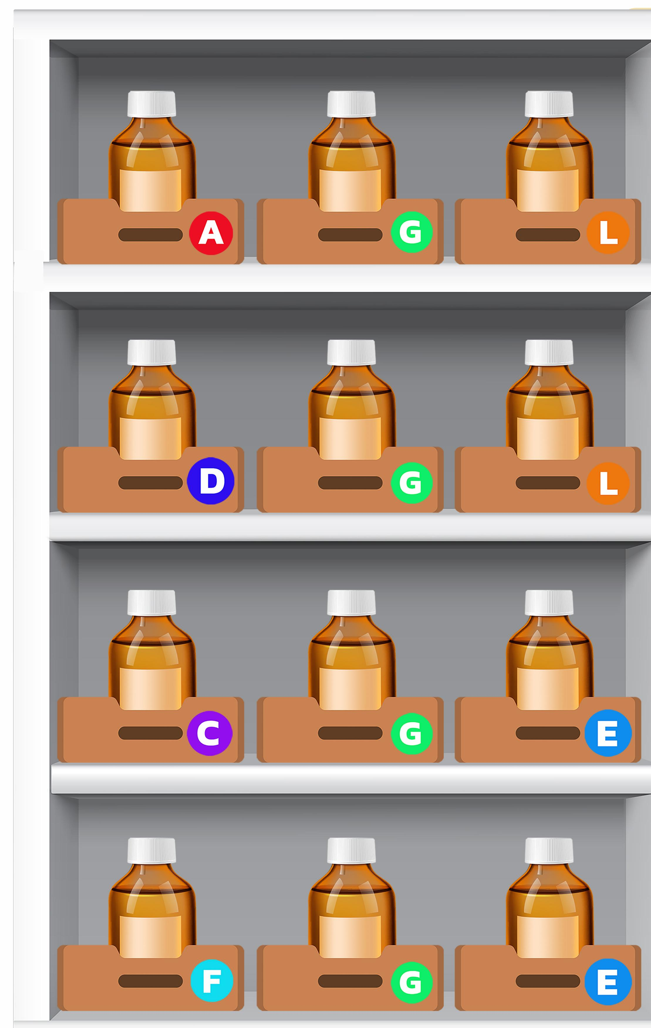
หากจำเป็นต้องจัดเก็บสารเคมีแต่ละกลุ่มไว้ในตู้จัดเก็บสารเคมีเดียวทัน สามารถจัดวางสารเคมีตามแผนผังนี้ได้ โดยแยกพื้นที่ของสารแต่ละกลุ่ม ไม่จัดวางของสารแบบ混杂 และติดตามตรวจสอบการจัดเก็บอย่างสม่ำเสมอ
