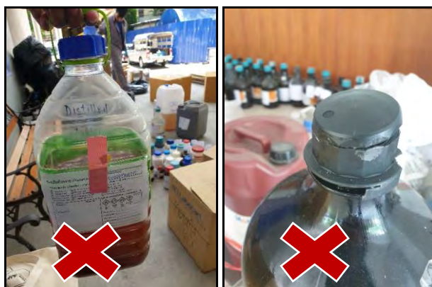
รูปที่ 4-9 ตัวอย่างภาชนะที่ไม่เหมาะสมในการใส่ของเสียสารเคมี
