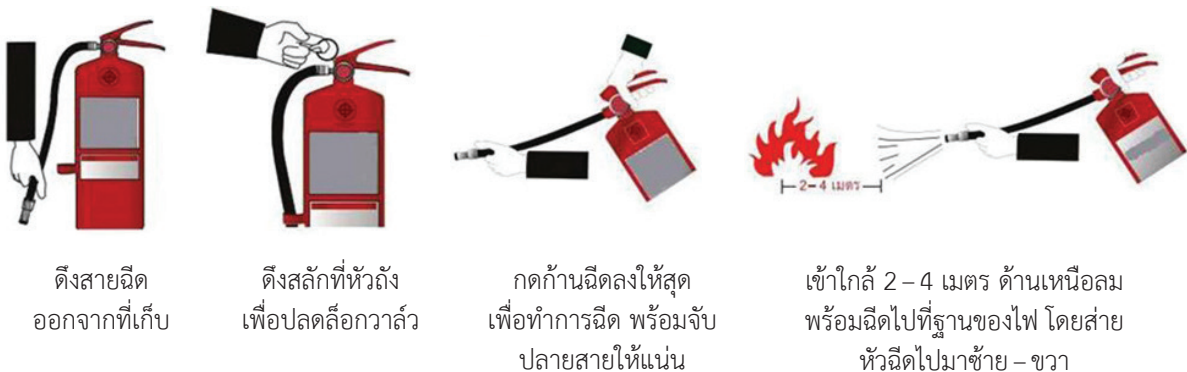
รูปที่ 44 การใช้ถังดับเพลิง
