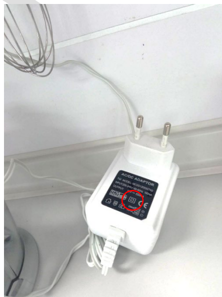
รูปที่ 14.3 สัญลักษณ์แสดงอุปกรณ์ไฟฟ้ามีฉนวนสองชั้นที่มีการใช้ในห้องปฏิบัติการ
