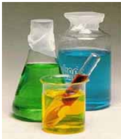
รูปที่ 8.1.5 การใช้แผ่นพาราฟิล์มปิดฝาภาชนะ
