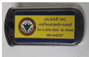
รูปที่ 12.1 แสดงอุปกรณ์บันทึกรังสีประจำตัวบุคคล (OSL)
