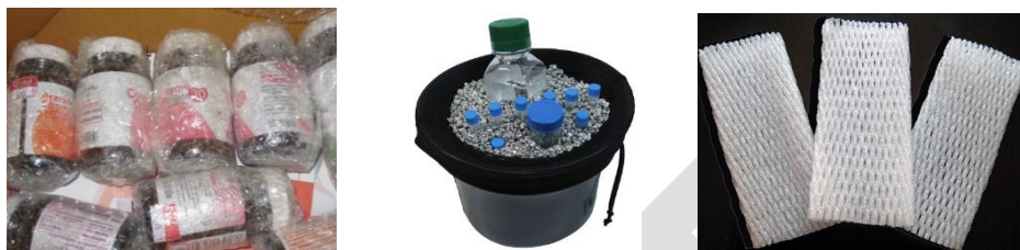
รูปที่ 8.1.8 ตัวอย่างตัวดูดซับสารเคมีและวัสดุกันกระแทกที่ใช้ในการกั้นระหว่างขวดสารเคมีขณะเคลื่อนย้าย
