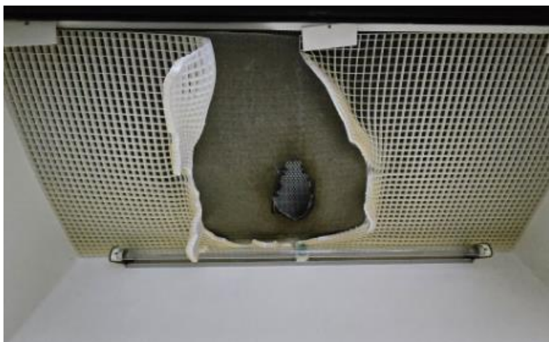
รูปที่ 2 ส่วนประกอบของตู้ชีวนิรภัยที่เสียหายจากอุบัติเหตุการใช้ตะเกียงแอลกอฮอล์
