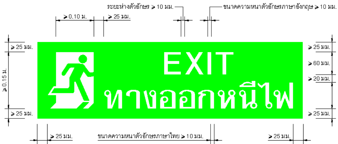
รูปที่ 3.10 ขนาดป้ายทางหนีไฟตามมาตรฐานกรมโยธาธิการและผังเมือง (มยผ.)
